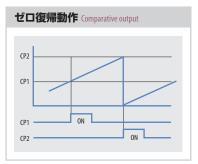
積算値がCP2の設定値に達した時に、積算値を「O」クリアし、再び積算動作を開始します。
