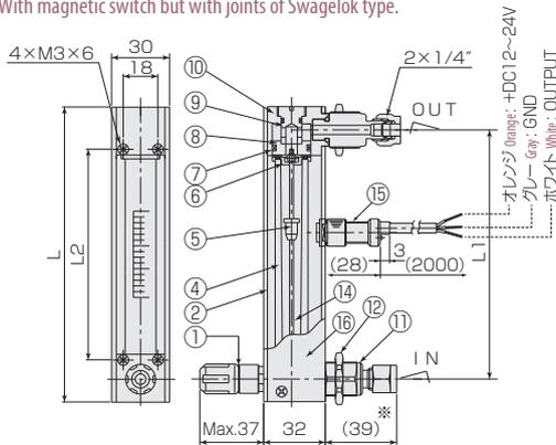
※ VCRタイプ継手付 With joint of VCR type : (37)
