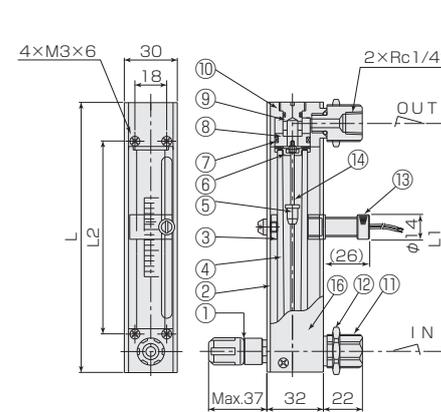
※ リードスイッチ付きの場合、磁性体パネルには固定できません。Flowmeter equipped with reed-switch is uninstalleable to magnetic panel
