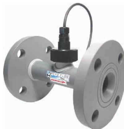
**注意** Caution 計測精度を保つため、IN側には10D(口径の10倍)、OUT側に5D以上の直管部を設けてください。
