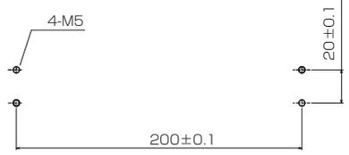
※接液部取付ネジは、M5×12以上のネジを使用してください。
